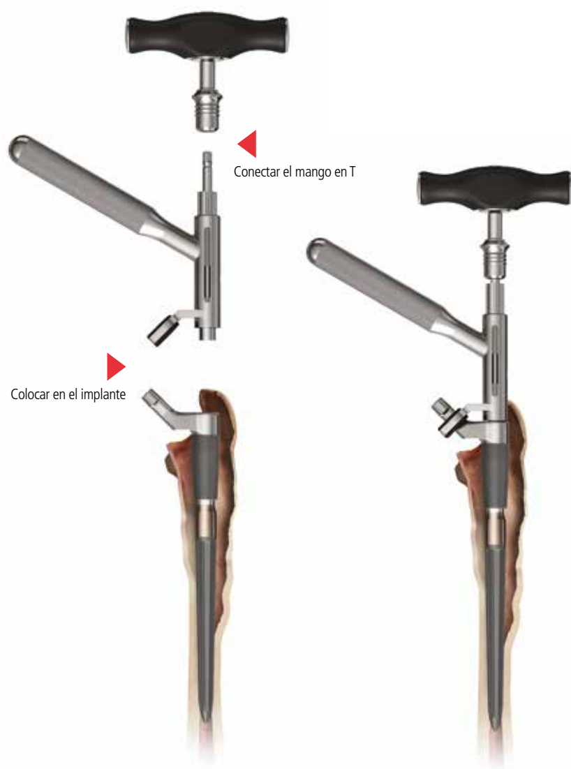
▲ Imagen 31 Montaje de la llave dinamométrica
