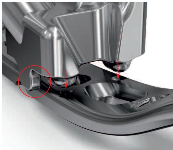
Introduzca el perno de interbloqueo ya ensamblado con su tuerca en el mango de inserción y enrósquelo a la placa hasta que quede bien apretado. Si utiliza la llave hexagonal pequeña para apretar el perno, asegúrese de que el agujero de la placa no resulte dañado. Apriete la tuerca con la llave combinada.
